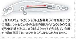
円筒形のウェイトがシャフト上を移動して飛距離アップに貢献。しかもウェイトの左右の遊びが少なくなるので泳ぎの安定感が向上。また球状ウェイトで発生していた転がり音が解消され、スレた魚にもストレスを与えません。
